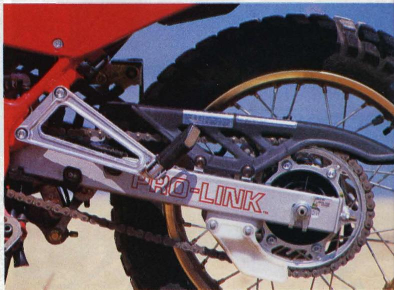
■ LA SOSPENSIONE POSTERIORE È REALIZZATA SECONDO IL NUOVO SCHEMA DELTA PRO-LINK, CON IL FORCELLONE SCATOLATO CHE AZIONA UN SISTEMA DI LEVERAGGI SIMILE A QUELLO DELLE CR ■
