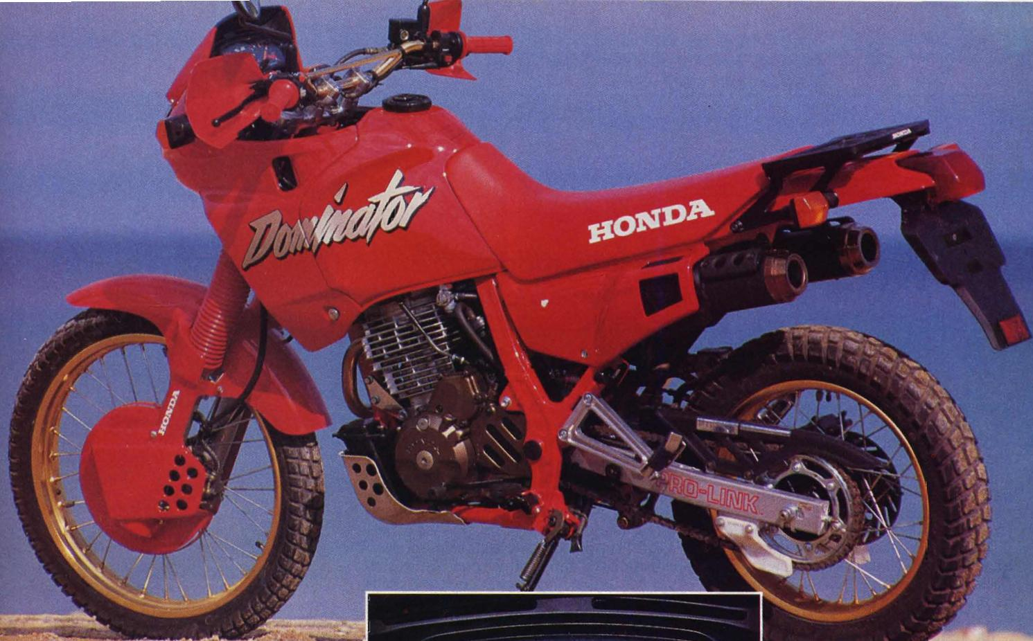
■ IL CUPOLINO HA FUNZIONI PREVALENTEMENTE ESTETICHE, E NON OFFRE UN GROSSO RIPARO AERODINAMICO. AL SUO INTERNO TROVA POSTO UN BEL CRUSCOTTO CHE OSPITA UNA STRUMENTAZIONE COMPLETA E DI PIACEVOLE DESIGN ■
